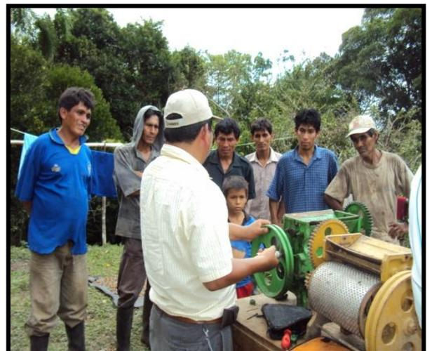
despulpadora no debe de mascar granos buenos, no debe de botar mucha cascara para realizar un buen lavado y así sacar un café de calidad y del mismo modo debe de estar bien lubricado para que los que despulpen no se cansen en operarlo.
