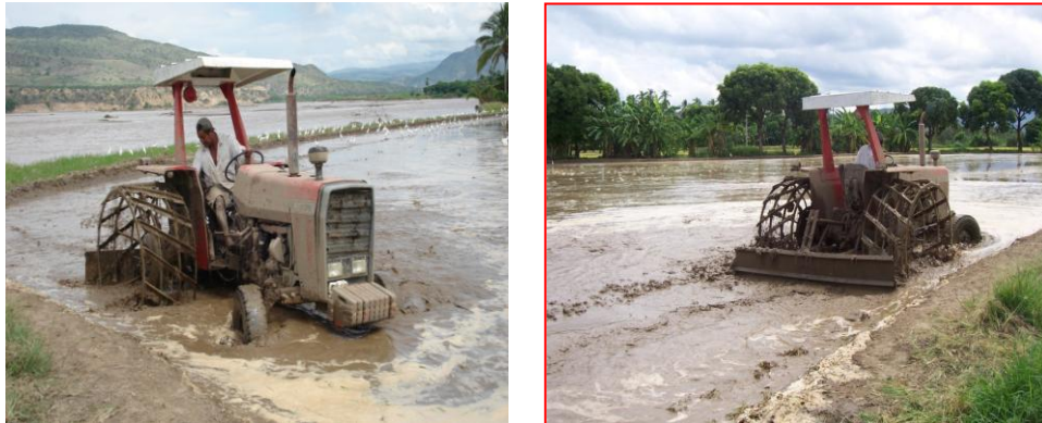
Fig. 2 Tractor con ruedas batidoras (lado izq.) Tablón de cuchillas que jala barro de las partes altas a las partes bajas (lado der.)
