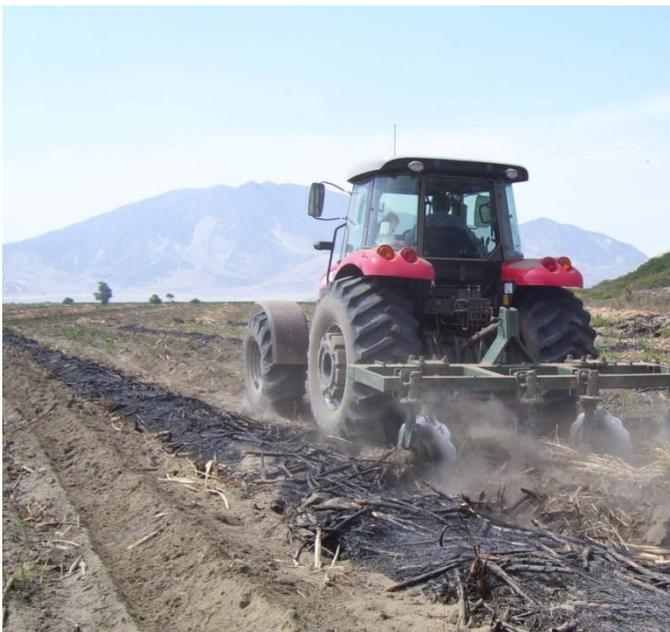
tractor de ruedas de 160HP que tenga un implemento llamado reacondicionador de surco que consta de cuatro discos invertidos entre sí y con cuatro puntas para optimizar el trabajo de los discos que formaran los nuevos bordos de los surcos.
