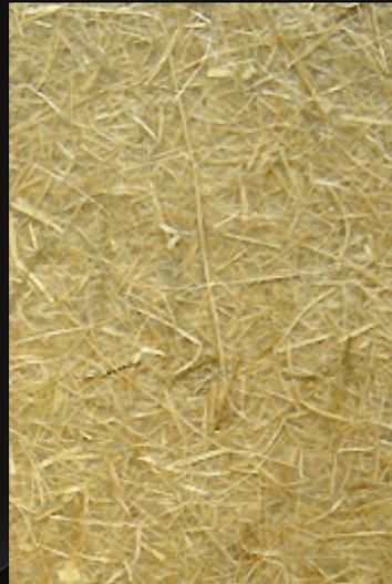
El empleo del prototipo de **PBS/fibra de bambú** ha permitido **disminuir en un 50% las emisiones del ciclo de CO2 sobre el polipropileno.**
